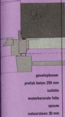
Detail 1. Horizontale doorsnede houten raamkozijn op overgang tussen houten en natuurstenen gevel. Schaal 1 : 12
